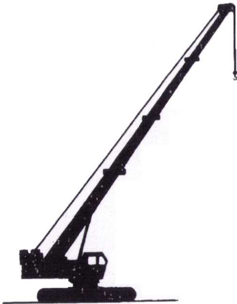
Sobre Orugas con Pluma Telescópica
